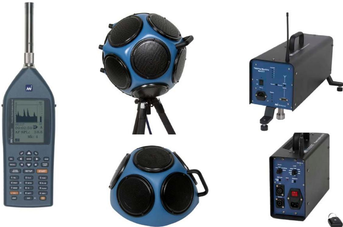
Strumentazione fonometrica di proprietà Ing. Angaramo Gabriele per catena di collaudo strumentale in riferimento al D.P.C.M. 5/12/1997 "Requisiti acustici passivi degli edifici"
